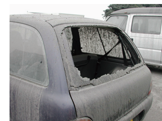
噴石で割れた車のガラス
